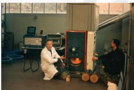
**1987 – 3 kW<sub>el</sub> za ORC postrojenje na biomasu u Italiji**
